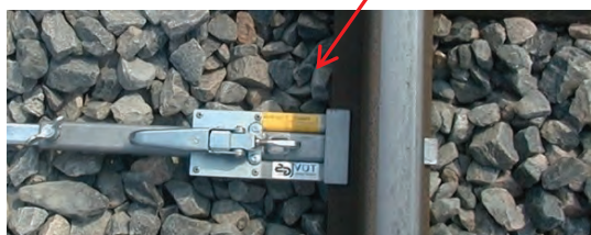
Signal Sh 2 mit Grundhalter System Hawart zur Befestigung am Schienenfuß, mit abgewinkelten Schilderhalter sowie EBA zugelassener Signalleuchte
