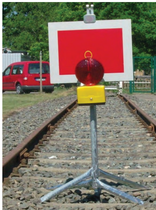
Signal Sh 2 mit Warnständer zur Aufstellung im Schottergleis oder im eingepflasterten Gleis
