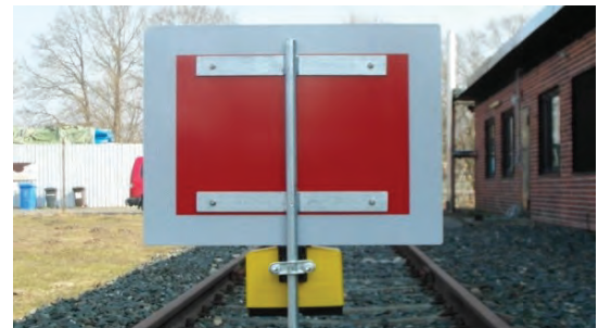
Signal Sh 2, mit Klemmständer, Rückseite bei Verwendung eines doppelseitigen Sh 2-Signals
